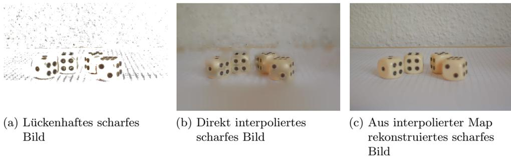
Abbildung 28: Direkte Anwendung des Interpolationsalgorithmus auf das lückenhafte scharfe Bild
